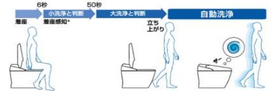
着座時間に応じて大・小の切り替えをします。センサーが6秒以上連続感知すると着座と判断しカウント開始。着座時間が50秒未満の場合は“小”。50秒以上は“大”と判断し、便座から立ち上がると自動で洗浄。
